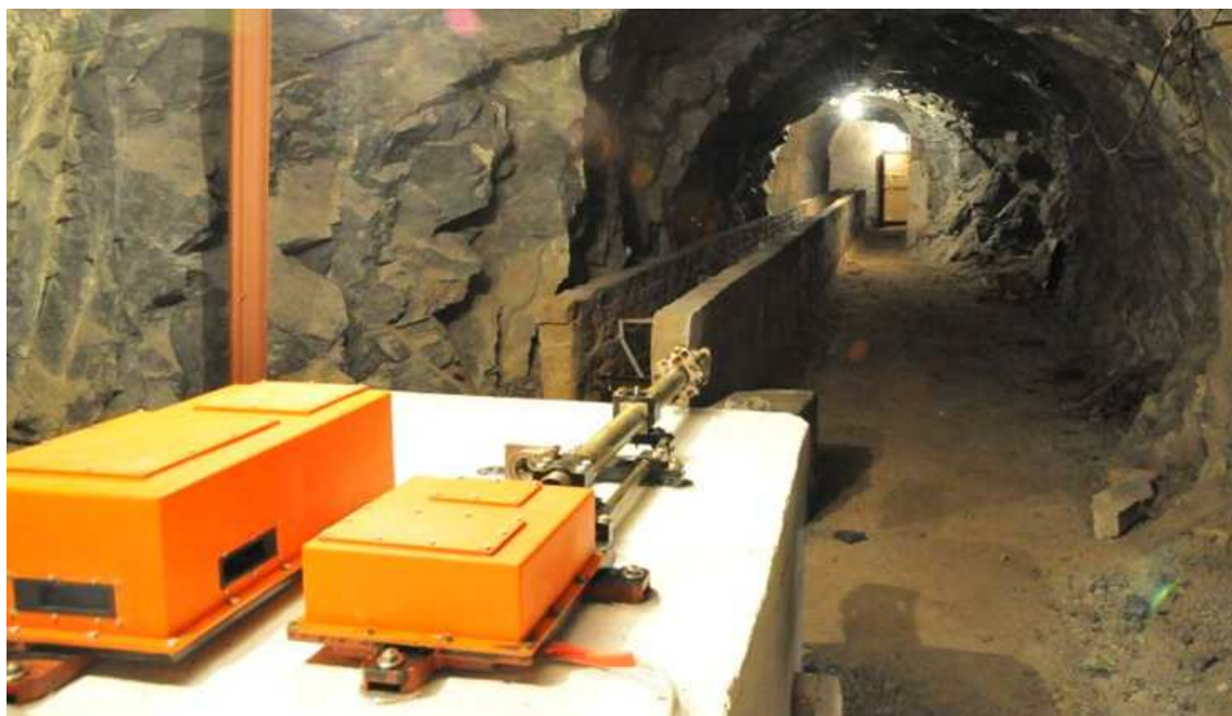
Рис. 6. Двухканальный лазерный измеритель деформаций на сейсмостанции «Талгар» (Алма-Ата)
