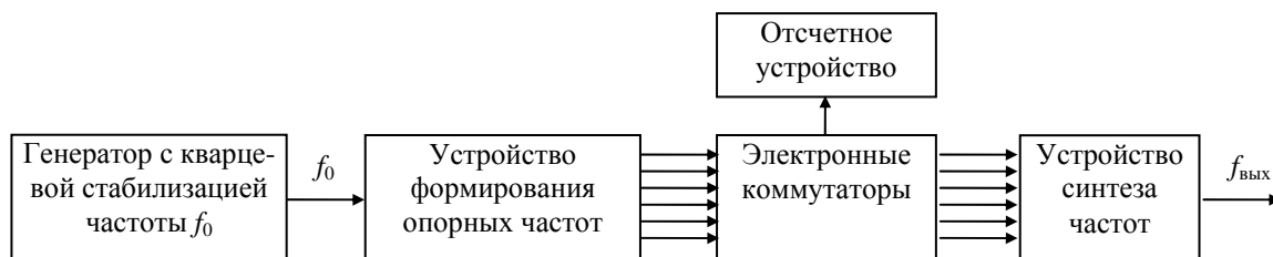
Рис. 2. Структурная схема синтезатора частота (прямой метод)
