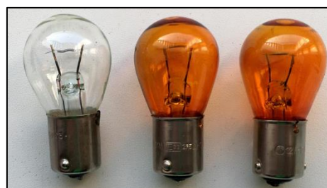
Рис. 11. Лампы накаливания используемые для измерения «холодного» сопротивления
