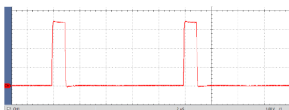
Рис. 18. Осциллограмма ШИМ OUTPUT TIM → ARR = 10-1; TIM2 → CCR4 = 1; // 10%
