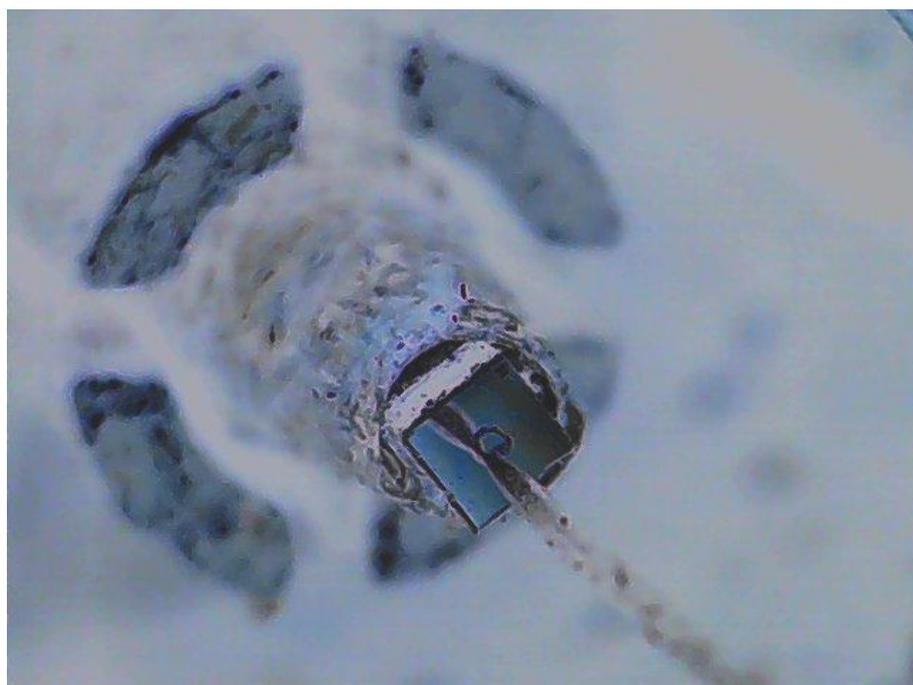
Рис. 2. Кристалл ЛФД-2а на держателе с контактирующей иглой
