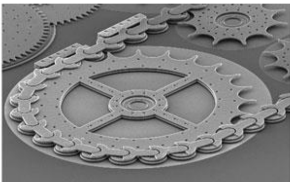
Рис. 17. Зубчатая и цепная передача по технологии MEMS из публикации [19]
