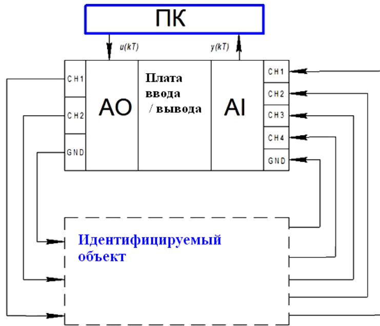
Рис. 2. Схема связи между персональным компьютером и идентифицируемым объектом
