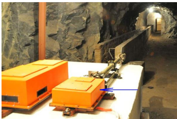
Рис. 6. Двухканальный лазерный измеритель деформаций на сейсмостанции «Талгар» (Алма-Ата), синей стрелкой показан блок компенсации влияния атмосферы
