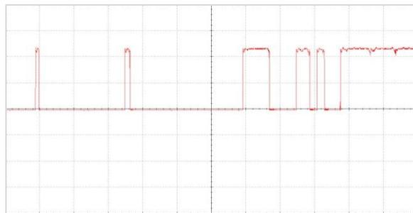
Рис. 26. Напряжение на лампе (дребезг контактов реле), 5 В/кл., точка 4, 100 мкс/кл
