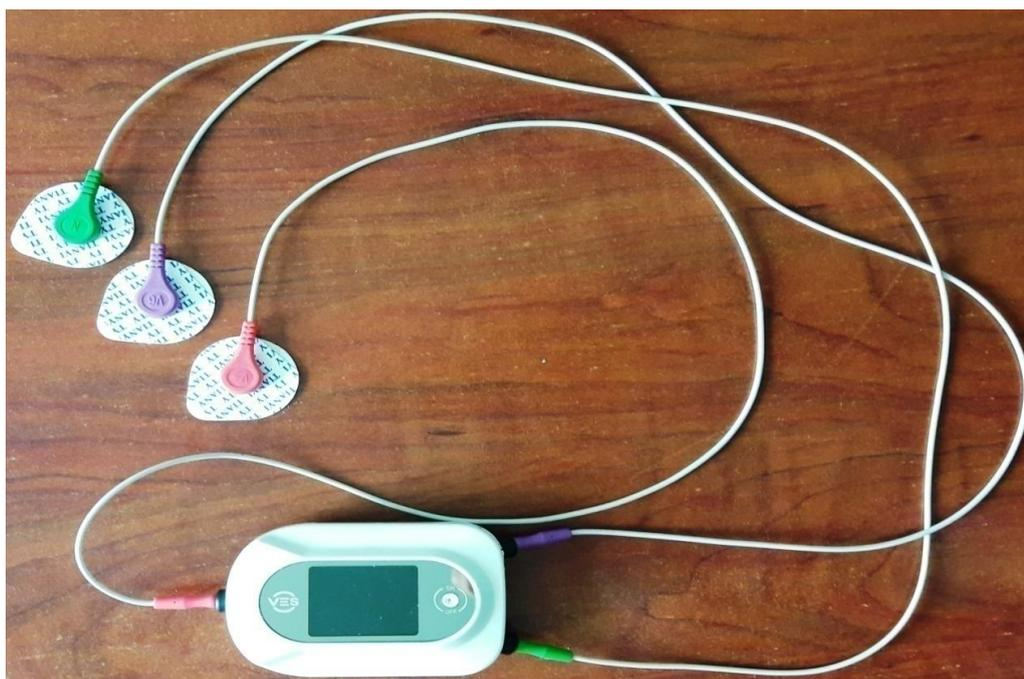
Рис. 2. Внешний вид мобильного измерительного прибора для диагностики состояния органов ЖКТ
