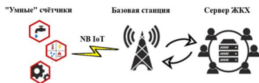
Рис.1. Организация сети связи по технологии NB IoT
