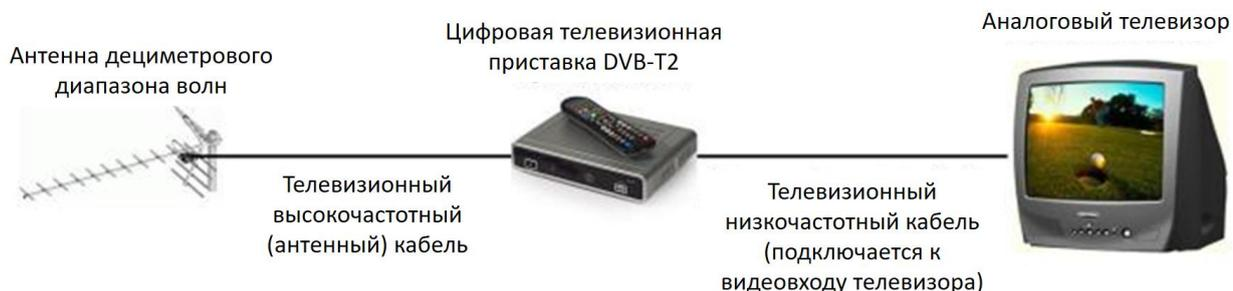
Рис. 1 Оборудование для приема эфирного ТВ сигнала DVB-T
