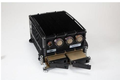
Phoenix International Phalanx II оптимизирован для SWaP и обеспечивает высокую производительность, большую емкость и безопасное хранение данных для беспилотных летательных аппаратов, подводных и надводных аппаратов, а также приложений разведки и наблюдения с экипажем.
