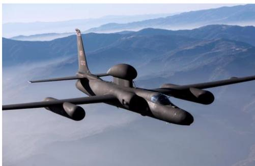
Усовершенствованная радиолокационная система с синтетической апертурой Raytheon-2 (ASARS-2) представляет собой многорежимную систему разведки с высоким разрешением в режиме реального времени, установленную на высотном разведывательном самолете U-2 Dragon Lady.
