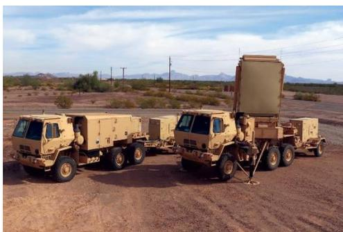
Радар противодействия огню Lockheed Martin AN/TPQ-53 обнаруживает, классифицирует, отслеживает и точно определяет вражеские беспилотники и приближающиеся артиллерийские снаряды.
