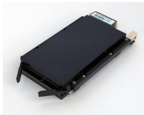
Phoenix International VPI-250-eSSDC — это модуль хранения данных на твердотельных дисках с шифрованием Open VPX NVMe Express (NVMe), сертифицированный по стандарту FIPS 140-2, который помогает разработчикам удалять устаревшие слои интерфейсов жестких дисков, такие как SATA и SAS.
